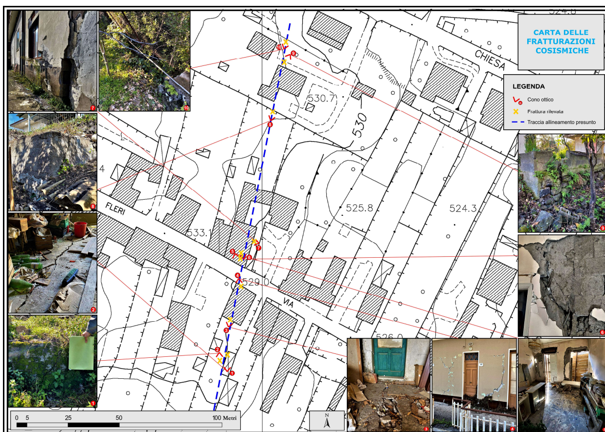
Figura 2.7.4.2 Carta del rilievo delle fratturazioni cosismiche
